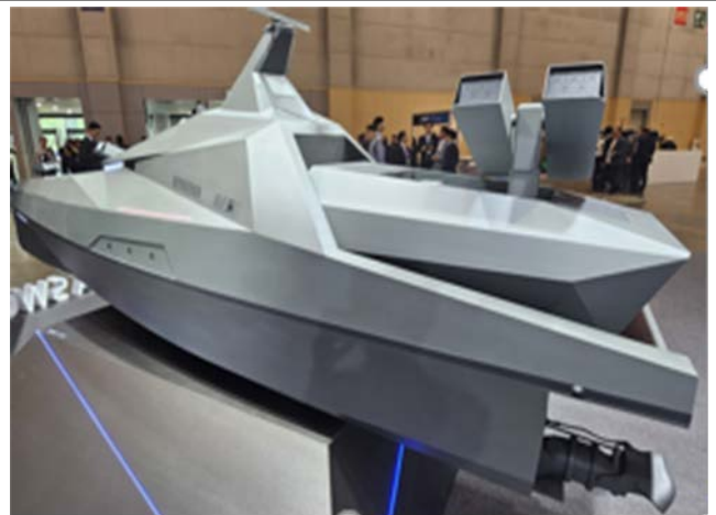
그림 120. 전투용 플래그십 USV '해검-X' (비공 탑재, 스텔스 적용)
