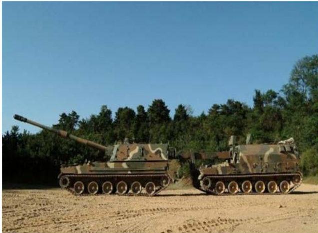
그림 167. K9 후미에서 자동으로 탄약을 보급하는 K10
