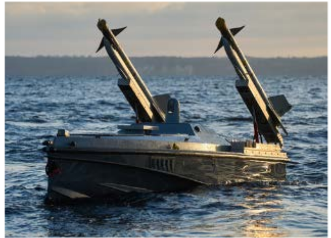
그림 109. 대공미사일 탑재된 Uforce 무인수상정 'Magura V7'
