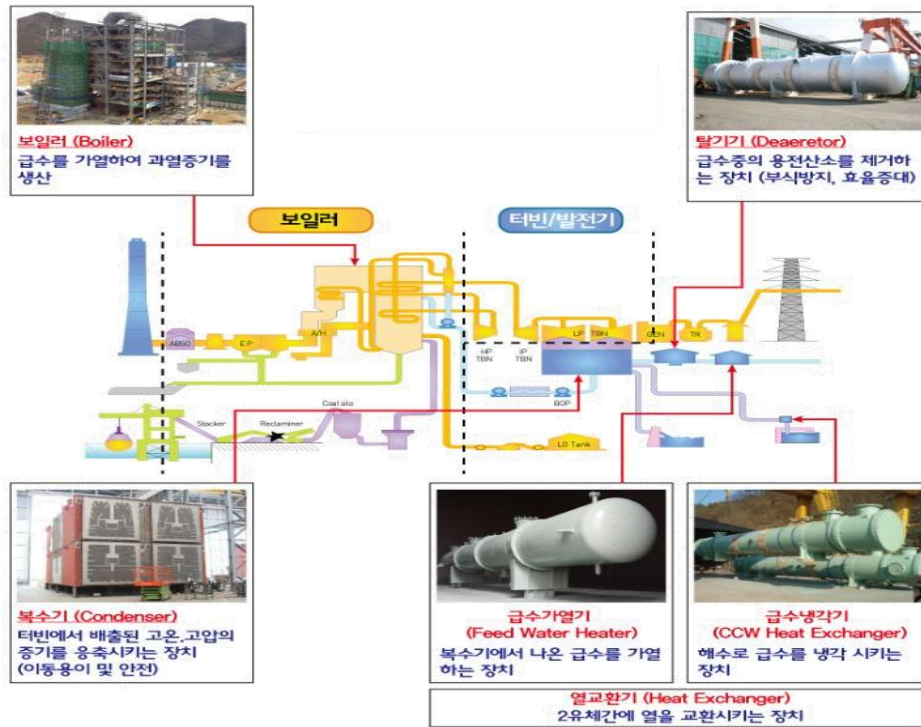
그림16. 화력 발전과정 및 비에이치아이 주요 제품
