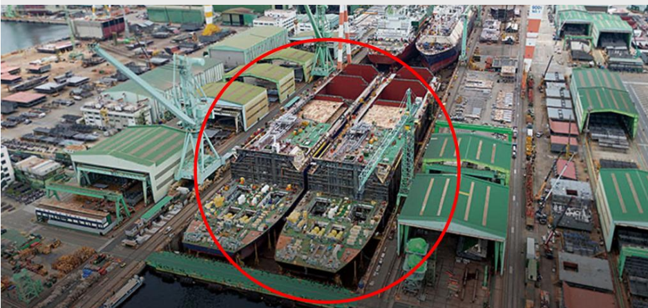
그림2 삼성중공업 3번 도크에서 LNG선 4척이 동시 건조 중인 사진
