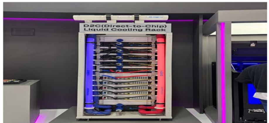
그림 21. LG유플러스 D2C 액체냉각 시스템: 기존 공기 냉각 대비 약 24% 에너지 효율 개선
