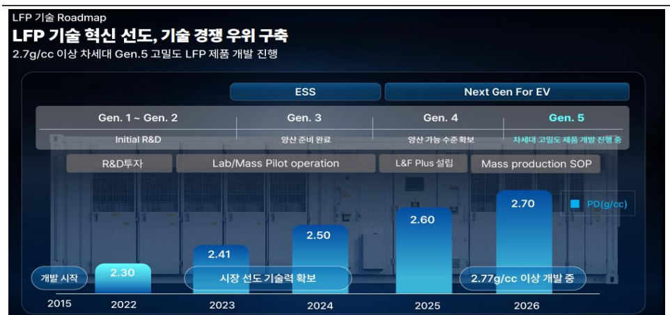
그림 5. 엘앤에프 LFP 기술 로드맵
