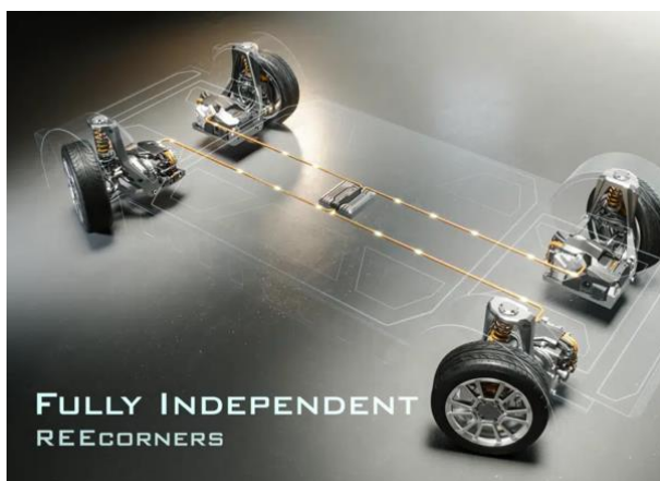
[그림34] X-By-Wire 개념 - 기구적인 정치를 전기 신호로 대체
