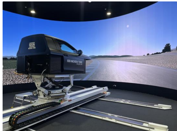
[그림13] 타이어 가상화 드라이빙 시뮬레이터
