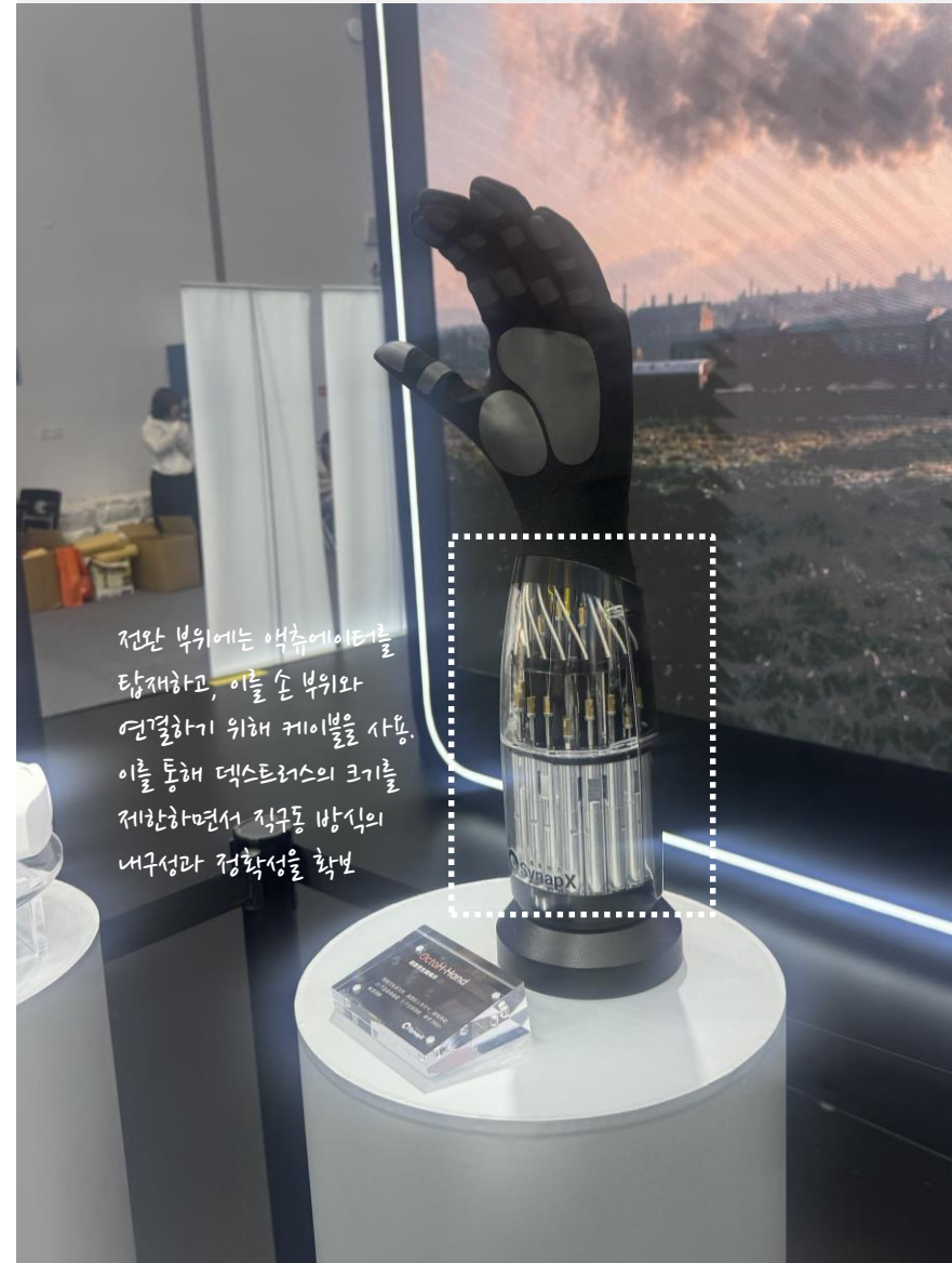
<그림> SynapX OctoH-Hnad (1): 전완 부위에 액추에이터를 탑재했으나, 해당 부위의 부피를 감소하면서 손목과 연결하기 위해 케이블 구조 혼용
