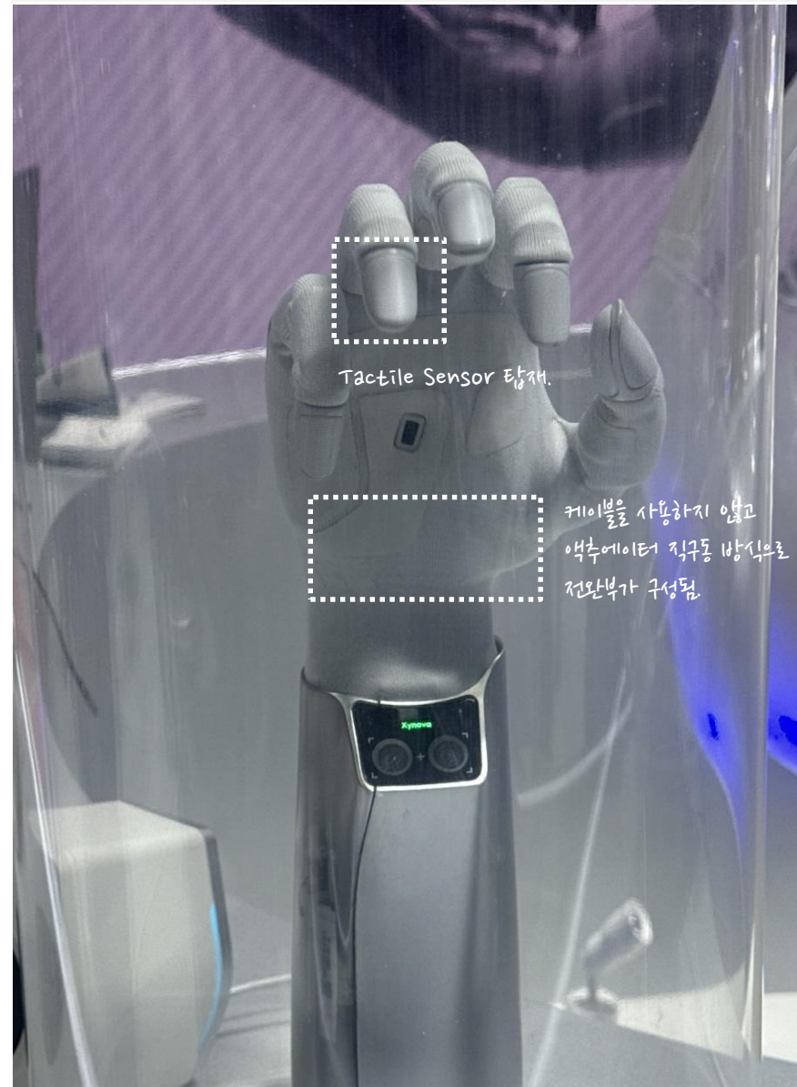
<그림> Xynova의 Prima 1은 순수 직구동 방식의 덱스트러스
