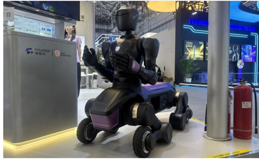
<그림> 차륜형 4족보행로봇 이동부에 휴머노이드가 결합된 제품
