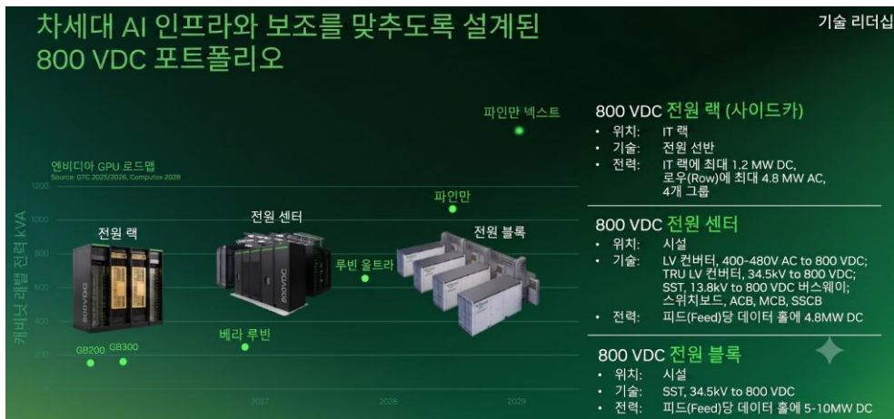
Fig. 28: 엔비디아 GPU 로드맵에 맞춰 준비하고 있는 슈나이더의 800VDC 포트폴리오
