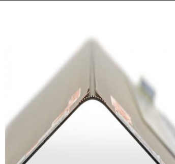
〈그림2〉 OLED하단부에 부착된 Backplate
