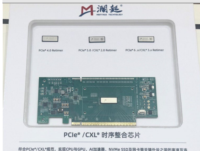
그림 26. Montage PCIe/CXL 리타이머 칩
