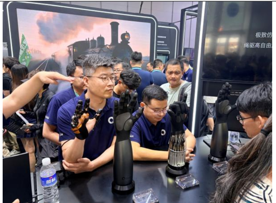
그림 25. 글러브 형태로 모방 학습이 가능한 로봇손 (SynapX)
