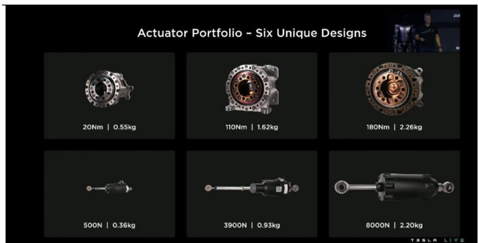
그림 63. Tesla의 액추에이터 종류 6가지(회전형 3가지, 직선형 3가지)
