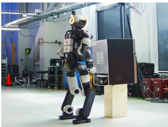
그림 85. BD의 아틀라스 등 뒤 교체형 배터리 2개 탑재 모습
