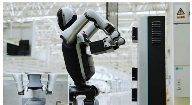
그림 86. UBTECH Walker S2 배터리 자가 교체 방식
