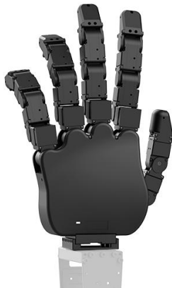
[그림4] 로보티즈 Hand(HX-5) - Manipulation 구현(20 DOF)
