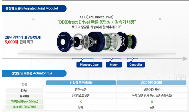
그림 211. SDD (SPG Direct Drive) 액추에이터 구조
