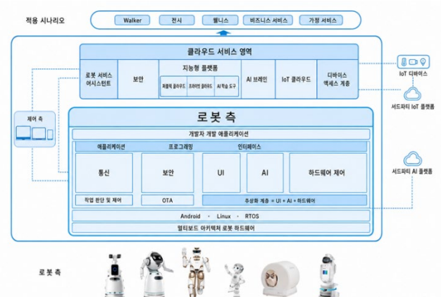
그림 134. 자체 개발한 로봇 운영체제 ROSA의 운영 흐름
