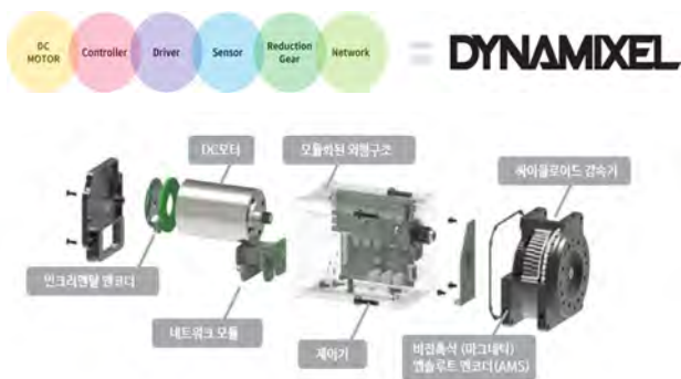
그림 184. 로보티즈 액추에이터 브랜드 “다이나믹셀”의 구조
