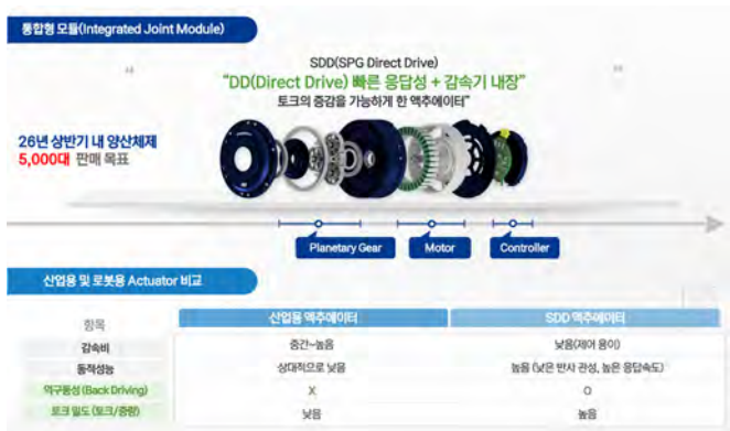
그림 211. SDD (SPG Direct Drive) 액추에이터 구조
