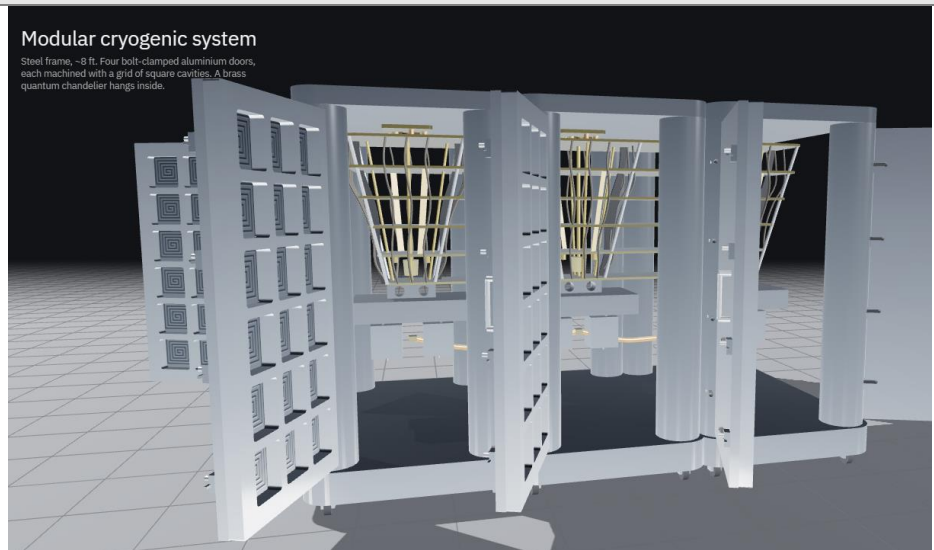
그림 4. 모듈식 희석냉동 시스템 확장 모식도
