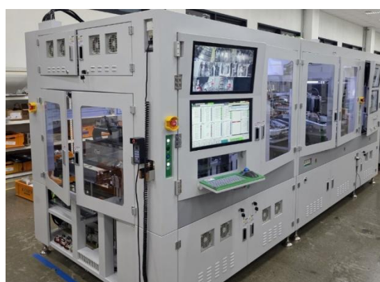
코세스 SOFC 전극 셀 자동화 장비
