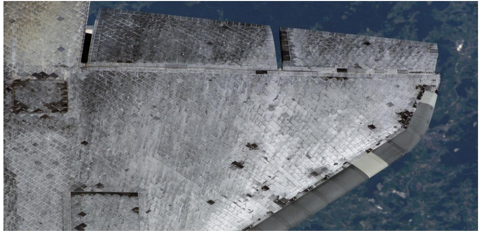
그림 7. 다양한 재료와 맞춤 부품으로 이뤄져있던 스페이스셔틀의 열차폐 방식
