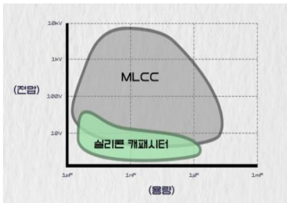
그림9 실리콘 캐패시터는 낮은 전압, 고용량이 영역을 담당
