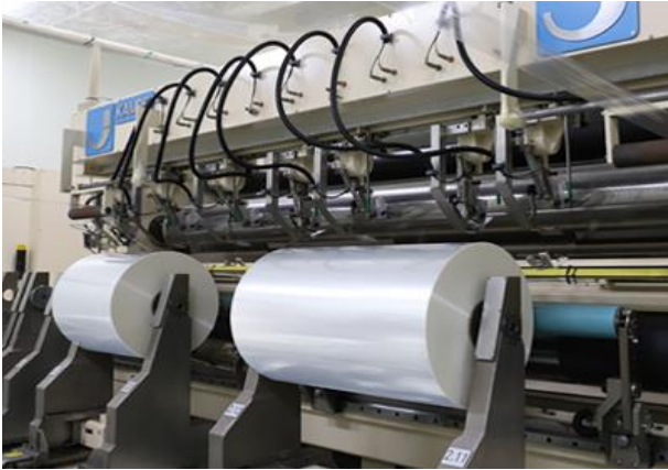
도표 10. 국내 청주 공장 커패시터 필름 생산 과정(PPC)
