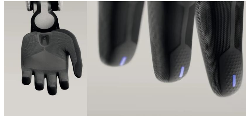
(Figure AI) 1세대 촉각 센서(tactile) 자체 개발 - 미세 압력 감지(3g) 가능
