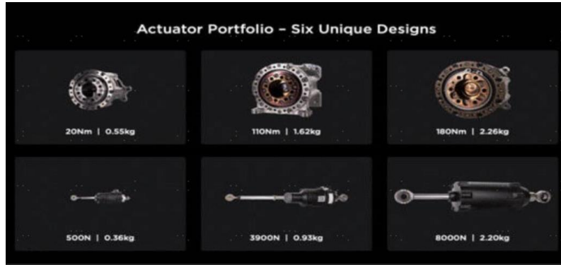
(Tesla) Optimus 적용 액추에이터를 리니어/로터리 각 3종으로 통합
