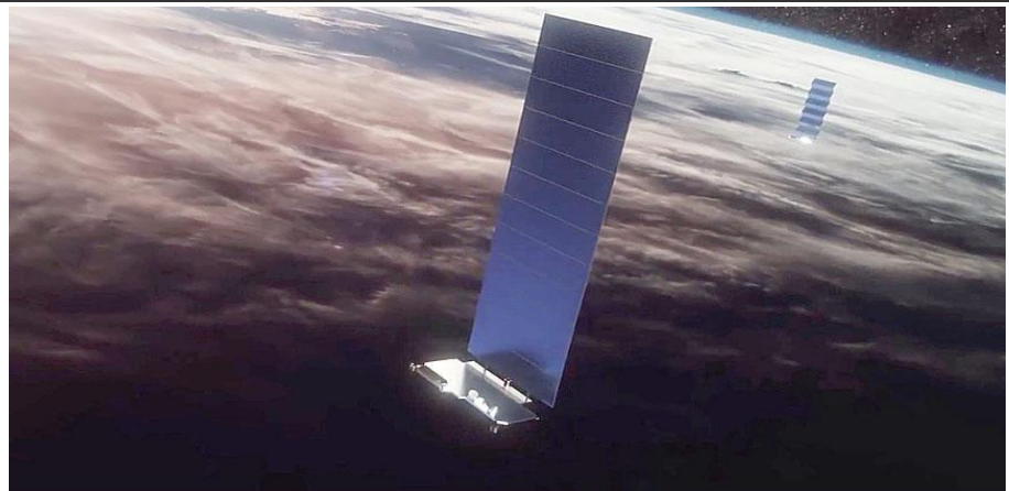
그림 53. 스타링크 V2 Mini 위성의 대형 태양전지판 전개 이미지
