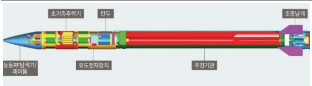
Fig. 18: 천궁 유도탄의 추진기관 등에 적용될 것으로 추정되는 카본 소재
